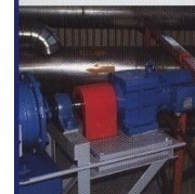
Digget om kraftoverføring til direkte drift på skruer til knurr. Fjernet girveiføring. Reduserte vedlikeholdsstunder.
