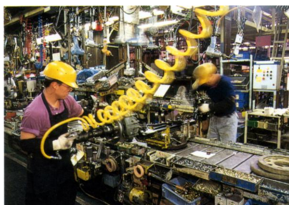
Takttiden på denne monteringslinjen for bakakslinger er lang. Derfor brukes et lite antall montører og hver montør håndterer en stor del varierende arbeidsoppgaver.
