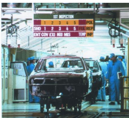
Nummererte varsellamper markerer hvor operatøren har trukket i stoppsnoren.
