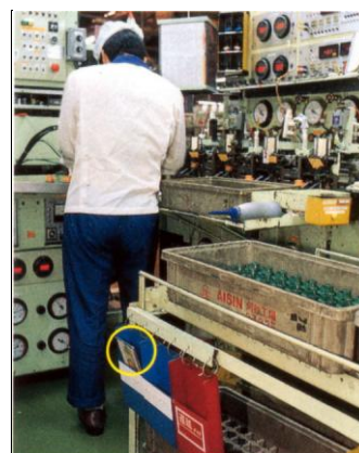
Produksjon etter instruksjon på produksjonskanban
