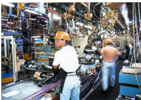
Takttiden på denne monteringslinjen for bakakslinger er kort. Derfor brukes et stort antall montører og hver montør håndterer en liten del av arbeidsoppgavene.
