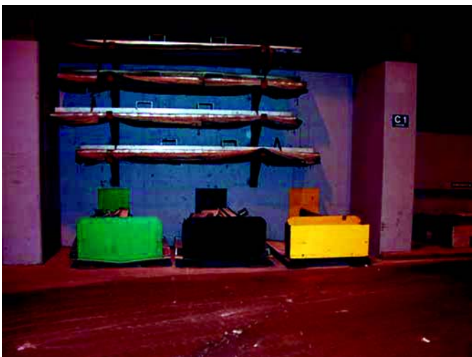
Eksempel fra Prebake på Karmøy der fargemarkering gjør at det blir vanskelig å legge utstyr feil.
