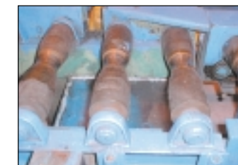
Pleksiglass under ruller for inspeksjon
