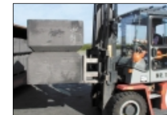
For lange gafler skader anodekull
